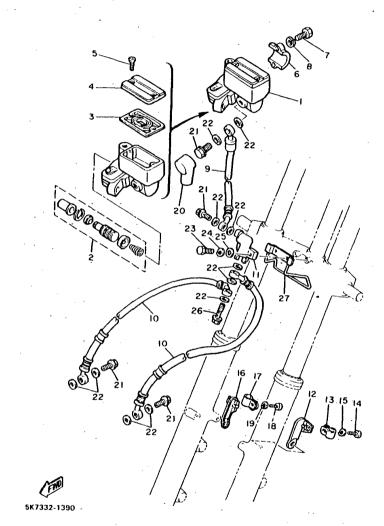
FIG. 39 FRONT MASTER CYLINDER
