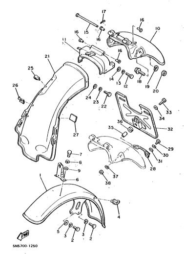
FIG. 25 FRONT FENDER. REAR FENDER
