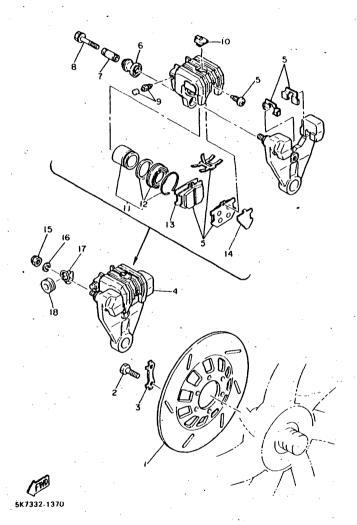
FIG. 37 REAR BRAKE CALIPER
